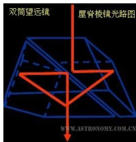
普罗式与屋脊式棱镜的作用都是让双筒望远镜所成的像是正像(上下不颠倒,左右也不颠倒)。大多数天文望远镜没有这么复杂的棱镜,所以往往成倒像(上下颠倒)或者镜像(左右颠倒)。
