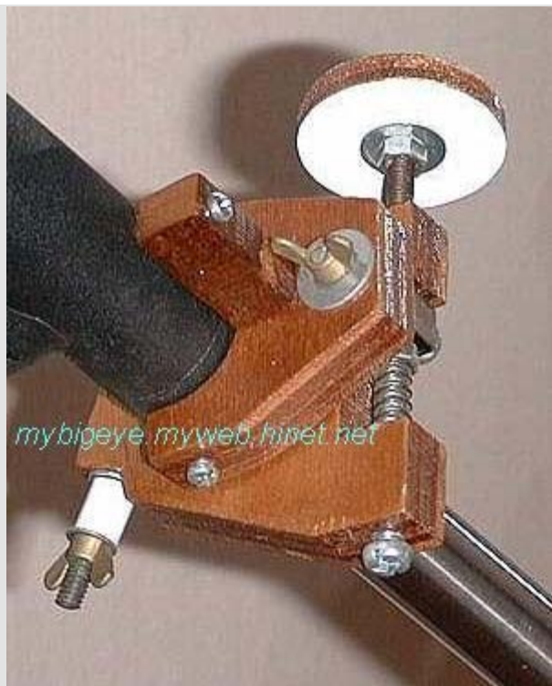
圖 10 完成的赤緯軸微調裝置
