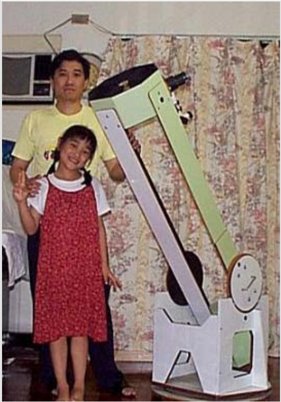
圖 2 自行裝配 25cm 口徑的望遠鏡
