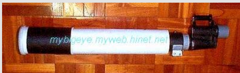
圖 18 以PVC塑膠管組裝之六公分口徑小望遠鏡（附正像稜鏡）
