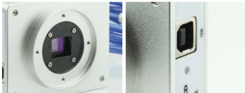
左：玻璃滤镜窗口 右：USB 插座及指示灯
