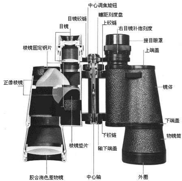
下图：双筒望远镜的结构（屋脊式）
