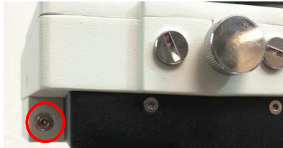
图 3：赤纬轴上的极轴分划板照明电源接口
