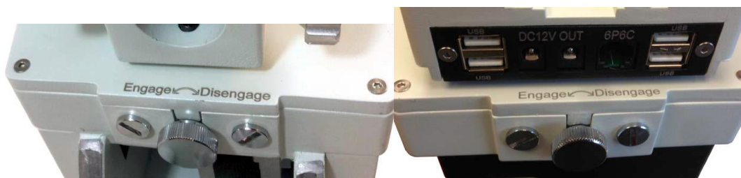
图 4:CEM60 的赤经离合螺丝（左）和赤纬离合螺丝（右）
