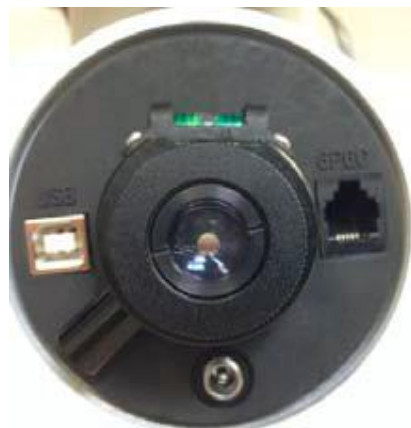
图 26:极轴镜照明 LED
