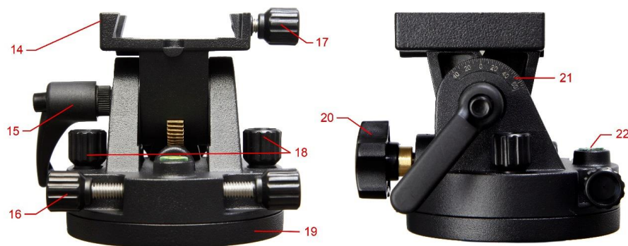
14.燕尾座 15.纬度(俯仰)锁紧扳手 16.方位调节旋钮 17.燕尾锁紧旋钮 18.方位锁紧旋钮 19.底座 20.纬度(俯仰)调节旋钮 21.纬度(俯仰)刻度 22.水平泡
