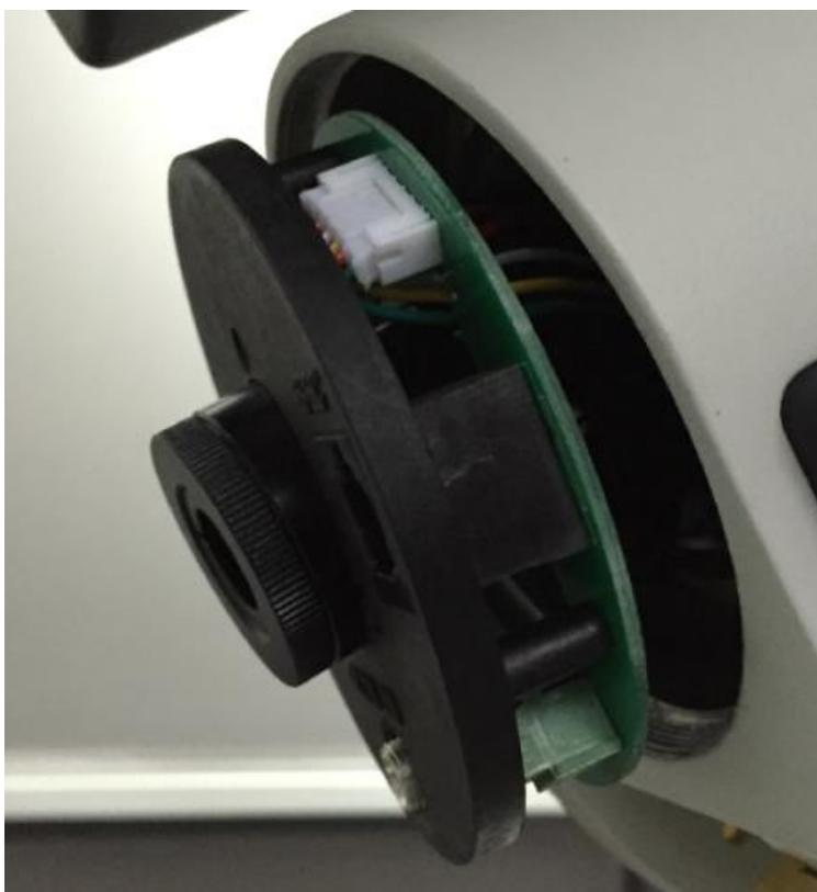
5. 用一字小螺丝刀小心翼翼翘开两个白色的插头，注意保护插座，如果针脚歪了，仔细拨正。视情况而定是否要拧下 PCB 版和面板之间的三颗固定螺丝以及拆下绿色的插头，可能是不需要的。
