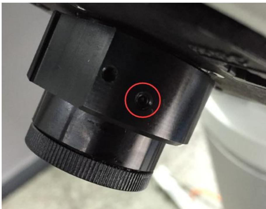
3. 用合适的六角扳手拆极轴镜周围三颗螺丝。
