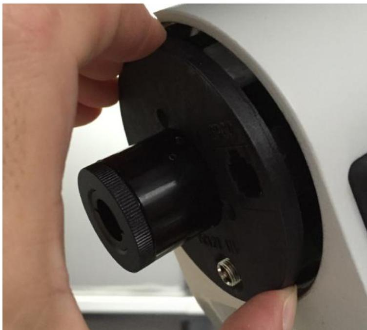
需要有些蛮力拉出，差不多到这样的程度，注意别破坏线缆，到能够看到三个接线头为止（我这样已经有些过头了，拉弯了插针）：
