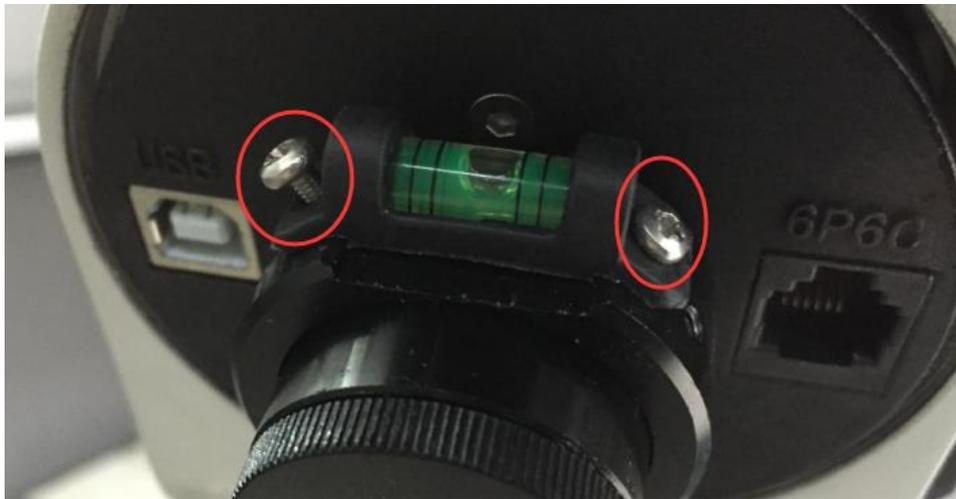
2. 用合适的六角扳手拆下固定水平泡的金属环。
