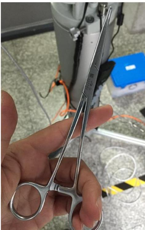
线缆沿赤纬轴孔洞穿下，用止血钳从极轴镜洞中夹出，效率很高。
