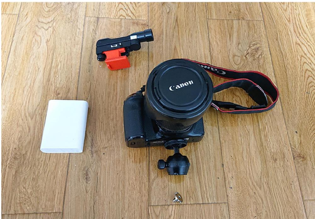
用 1/4 英寸手拧螺丝，把球型云台固定在赤道仪的 L 型支架上。
