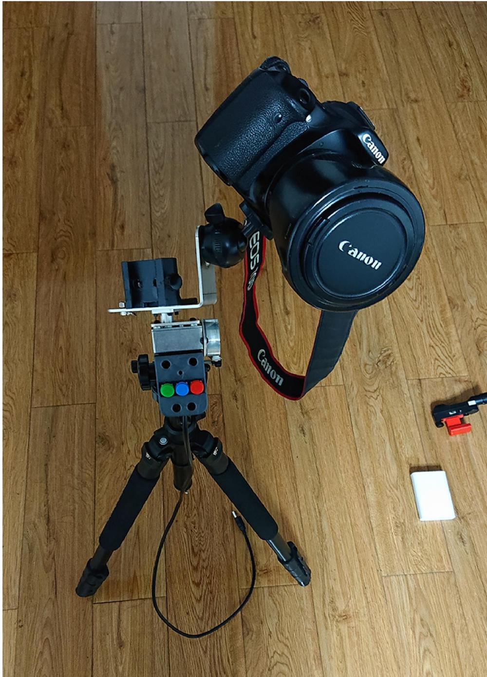
相机对准目标之后，可以把赤道仪的 USB 线插入充电宝。赤道仪上电就开始跟踪了。
