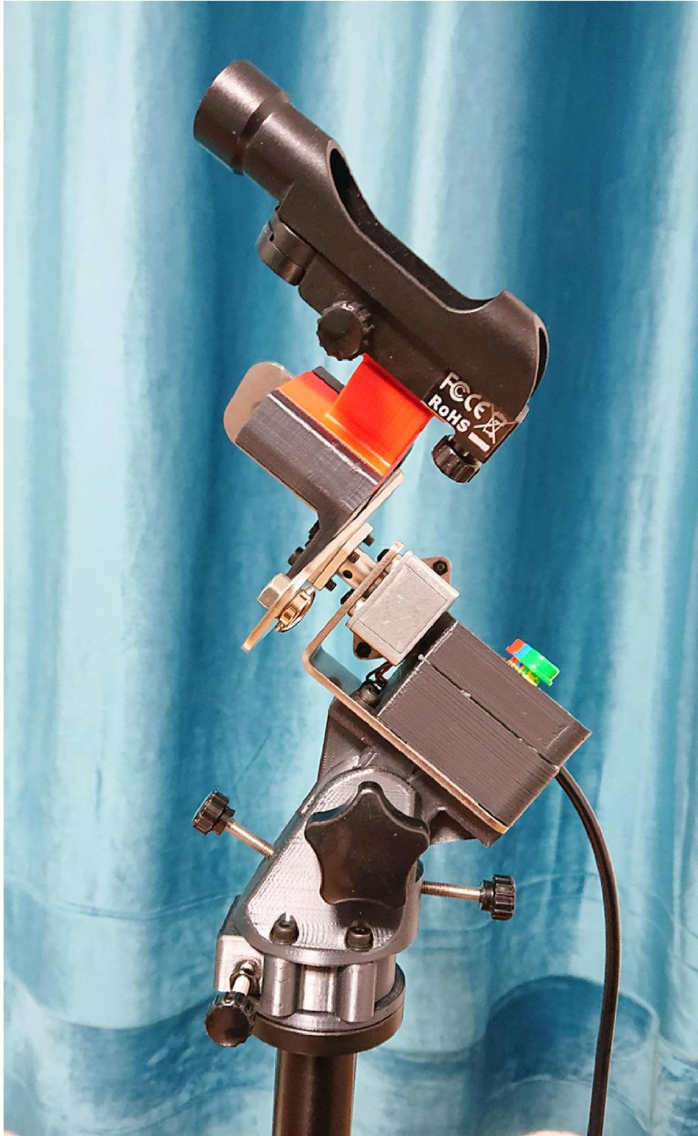
对好极轴之后，请取下寻星镜。避免与赤道仪或三脚架在特定的角度被卡死。
